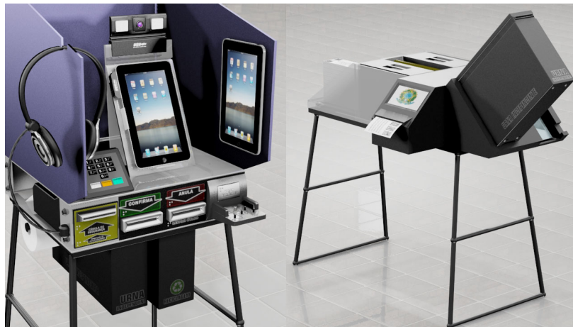
Figura 1 - À esquerda, Mesa Receptora Independente e à direita, Máquina Apuradora
